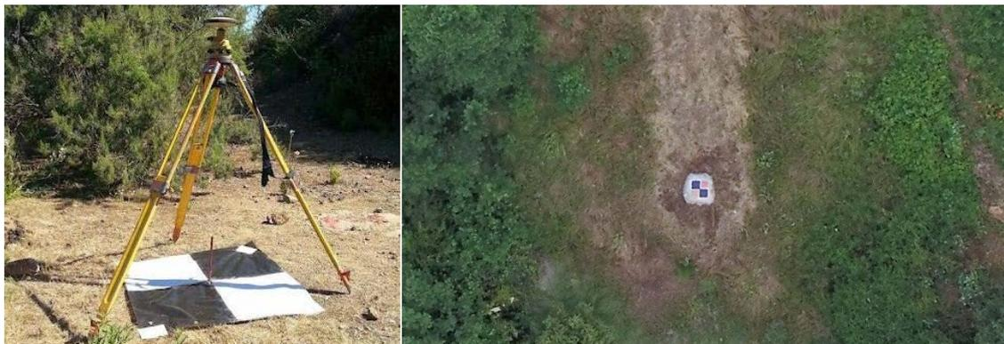
Ilustración 17. Punto de control terrestre con lona tipo ajedrez. Fuente: Internet
